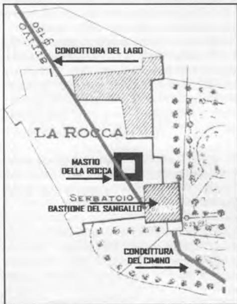
Pianta della Rocca con il tracciato delle condutture dei due acquedotti
